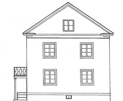
Gavelfasaden på Grävlingen 3 med ett tydligt avgränsat gavelfält i form av en bruten fronton, det vill säga ett brutet listverket. Nyköpings Stadsarkiv.
