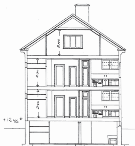
Sektion av Grävlingen 5. Lägg märke till kökets inredning med vedspis till vänster. Nyköpings Stadsarkiv.
