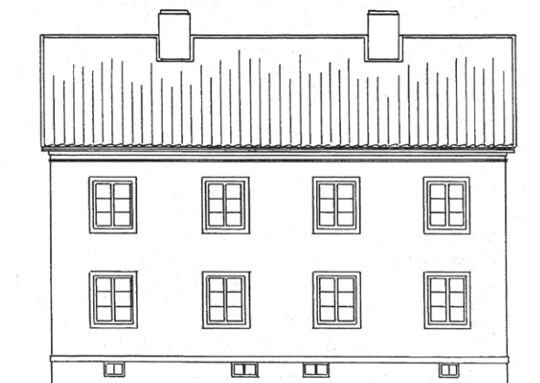
Fasaden åt motsatt sida av entrén över Grävlingen 3. Notera källarens fönstersättning som inte följer de övriga våningarna. Nyköpings Stadsarkiv.
